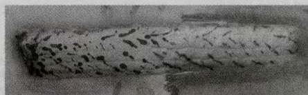
(a) 堆焊试样裂纹形貌
